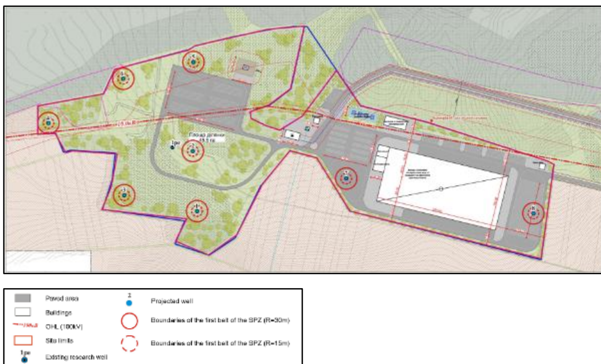
Рис. 3. План проєктованої ділянки із зазначенням 1-го поясу (зони суворого режиму) зони санітарної охорони (ЗСО) свердловин
